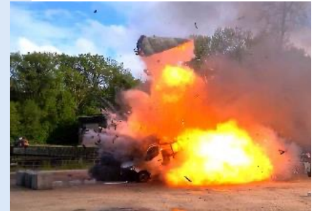
Essai sur véhicule hydrogène
