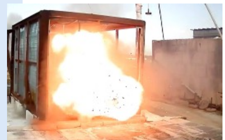
Essai d'emballage thermique d'une batterie Li-Ion
