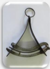
Une éprouvette de Régnier pour mesurer la force de la poudre
